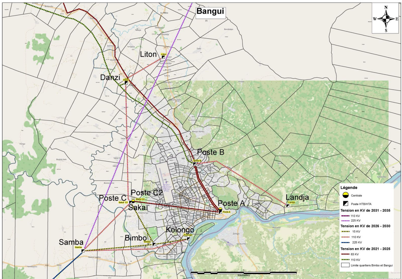
Figure 1: Evolution du réseau de transport de Bangui à l'horizon 2040
